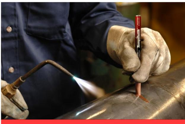
Обеспечивая точность, надёжность и удобство во обращении в течение более 80 лет, Tempilstik это уникальный термоиндикаторный карандаш, считающий в себе точность и удобство в обращении для измерения температуры поверхности. Специально разработанный для точного измерения температуры в процессе подогрева, в промежуточные моменты и в процессах послесварочной термообработки, Tempilstik является ведущим выбором для выполнения самых экстремальных задач.
