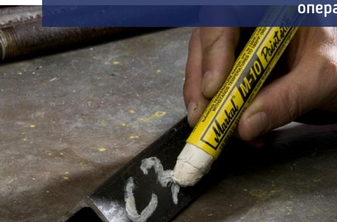
Стержни с твердой краской M® Paintstik® и M-10® Paintstik® предназначены для операций отжига и термообработки, позволяют делать отметки при комнатной температуре, сохраняя свои рабочие характеристики при нагреве до 982 °C (1 800 °F).
